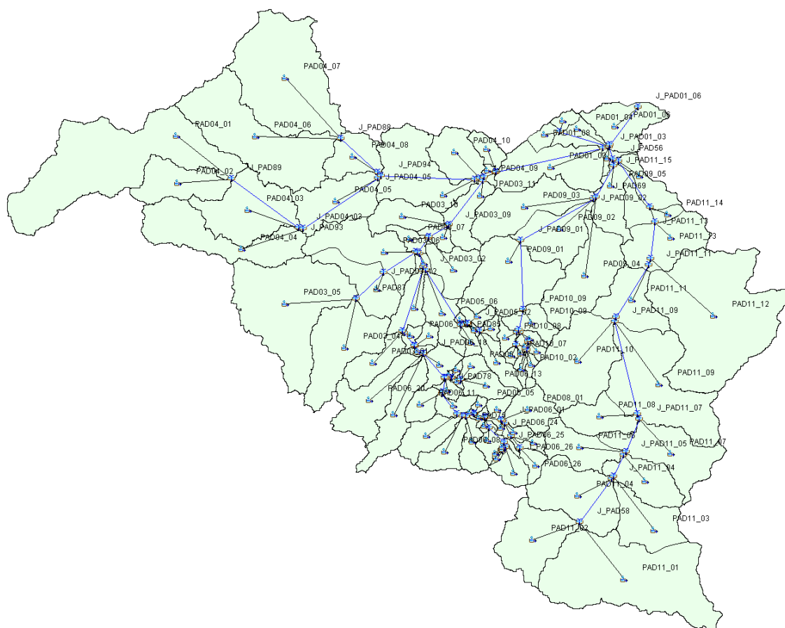
Figura 3.8 - Schematizzazione dei sottobacini del Padrongianus tramite modello idrologico in HEC-HMS.
