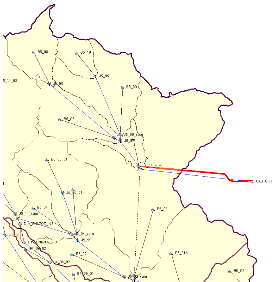
Figura 5.15 Schema del modello idrologico in HEC-HMS – Rio Abba Fritta.
