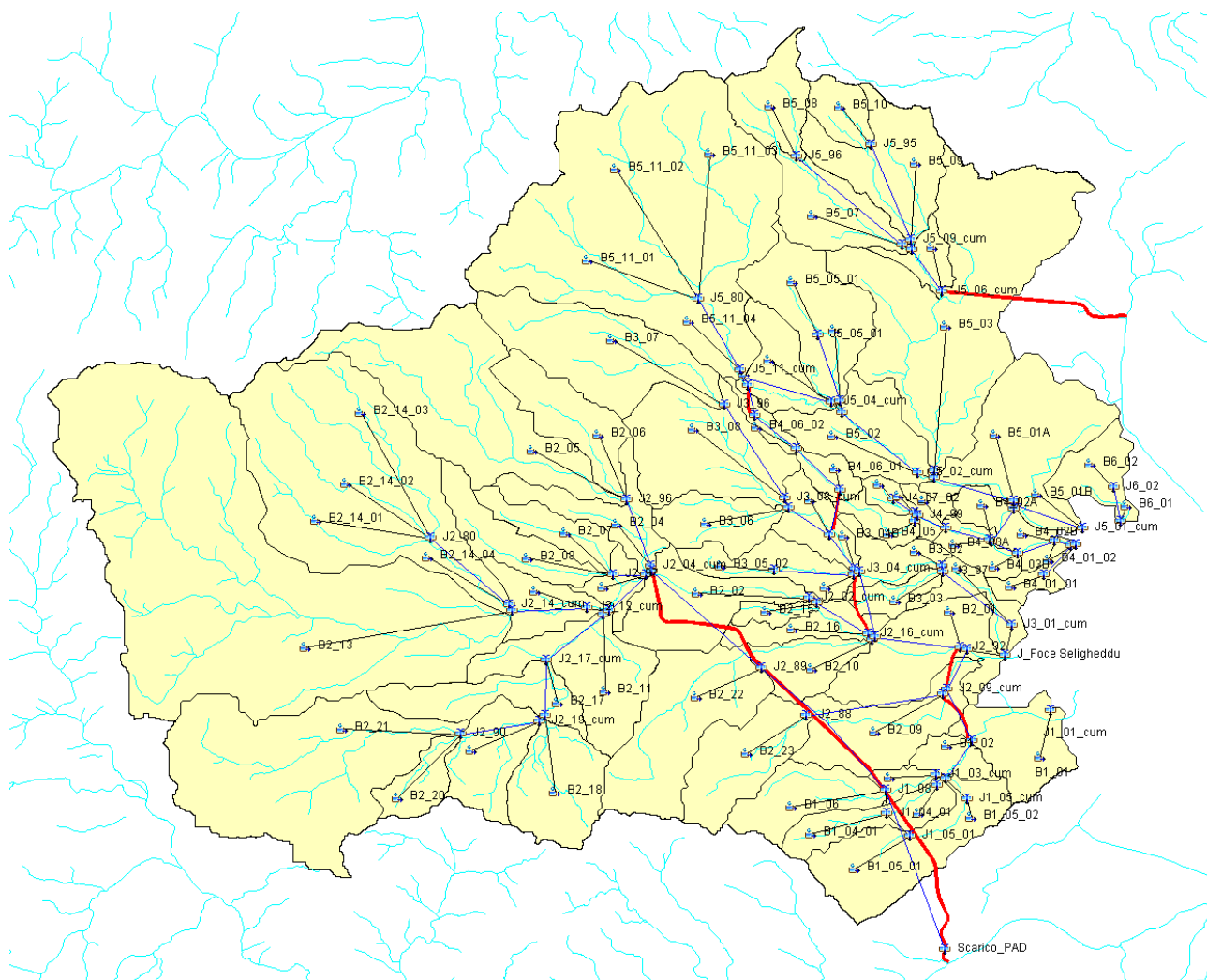
Figura 4.6 Schema del modello idrologico sviluppato in HEC-HMS.
